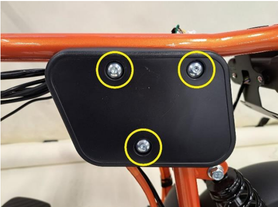
Irrota istuimen alapuolen vasemman sivumuovin kiinnityspultit (kuusiokoloavain 5 mm).
