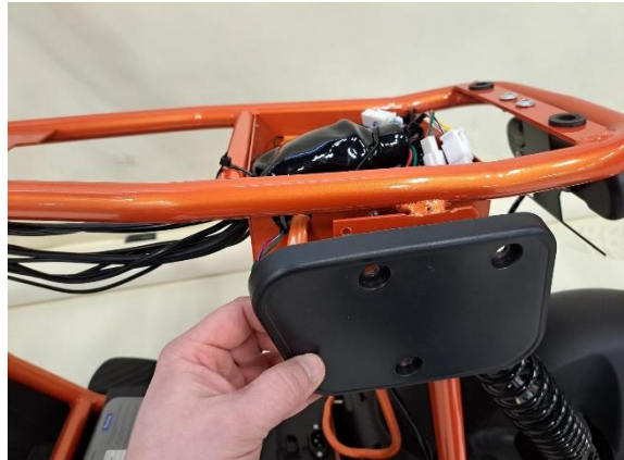
Ota istuimen alapuolen vasen sivumuovi pois.
