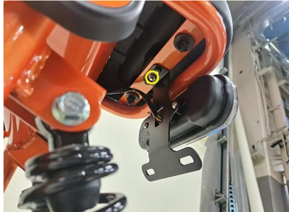
Irrota istuimen kiinnitysmutteri (kiintoavain 10 mm).
